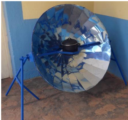
Solarkocher von der Mechanikergruppe in Songea hergestellt. Reflektorbleche kommen aus Deutschland sind finanziell unerschwinglich!
