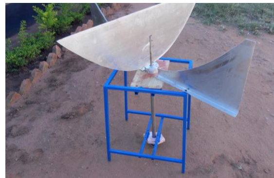
Schablone zur Anfertigung von parabolförmigen Solarreflektoren.
