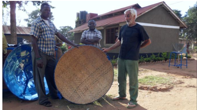
Reflektorkorb aus Bambusstreifen gefertigt, dessen Wölbung ist jedoch als Solarreflektor nicht geeignet (Bambusstreifen waren zu breit)!
